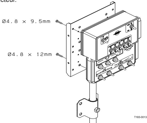
Les câbles doivent avoir une section d'au moins 4 mm pour assurer une alimentation suffisante. Le circuit électrique du tracteur doit disposer d'un fusible de 8 A pour le boîtier de commande régulation et d'un de 16 A pour le boîtier de commande rampe.
