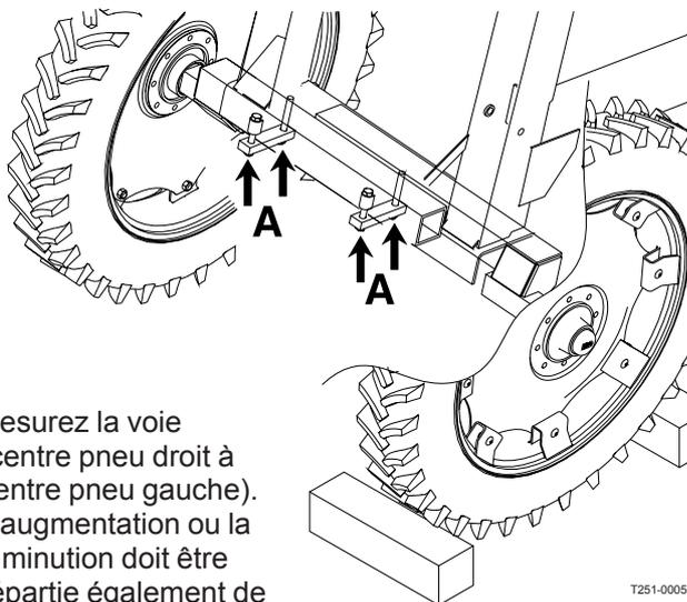
1. Mesurez la voie (centre pneu droit à centre pneu gauche). L'augmentation ou la diminution doit être répartie également de chaque côté.
