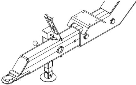
Lorsque le pulvérisateur est attelé, la béquille se range dans le support prévu à cet effet sur le côté droit de l'appareil. Pour la sortir, remontez la, enlevez la goupille de sécurité et retirez la béquille du support.
