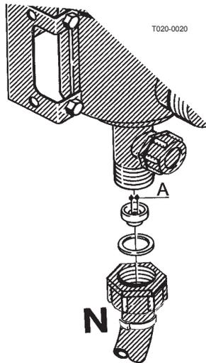
Lorsque vous nettoyez le filtre, enlevez le tuyau **N** et vérifiez sa propreté. Le maillage standard du filtre est de 80 mesh. Des filtres de 50 et 100 mesh sont également disponibles. Pour accéder au filtre, dévissez la partie supérieure du carter.
