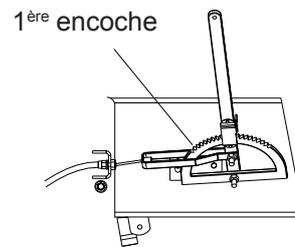
**NOTA !** Le réglage suivant doit être effectué simultanément sur les deux freins. Passez de l'un à l'autre au fur et à mesure.
