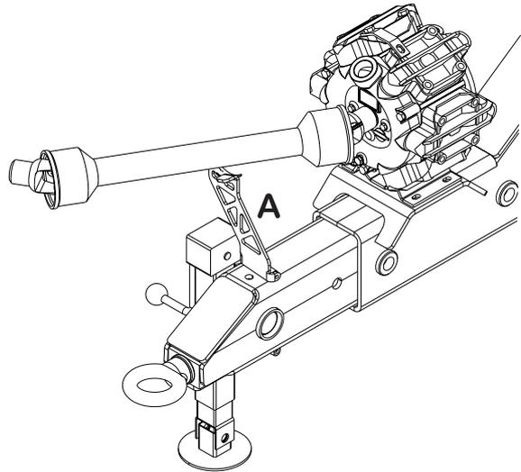
Sur les flèches version haute, l'arbre de transmission se fixe dans le crochet au dessous de l'attelage.
