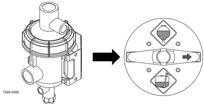
**IMPORTANT !** La vanne Manifold jaune est normalement toujours ouverte, mais doit être fermée dans les cas suivants :
