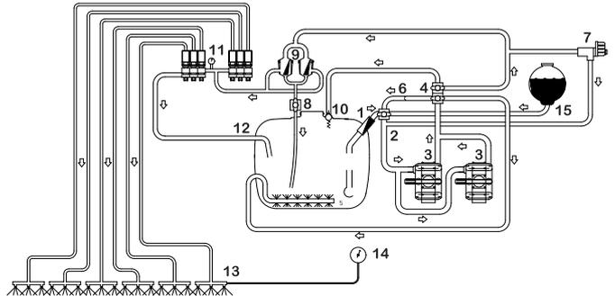
1. Videz la cuve de pulvérisation au maximum. Tournez la vanne de refoulement verte sur "Sans agitation" et traitez jusqu'à ce que la pression au manomètre soit à zéro.
