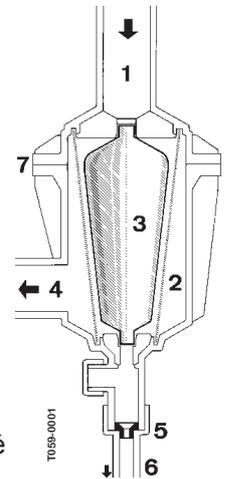
Le filtre autonettoyant est commandé par la vanne Manifold JAUNE.
