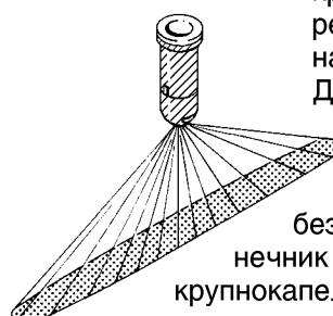
4. Пенный наконечник устанавливается вместе с коническим наконечником, но без завихрительной пластины. Пенный наконечник имеет те же преимущества, что и крупнокапельный. Он создает тот же рисунок распыления, что и плоский наконечник, но со значительно большим углом рассеивания. Этот наконечник применяется, главным образом, с почвенными гербицидами, при использовании которых нельзя допускать сноса ветром, а также с некоторыми видами жидких удобрений, поскольку крупные капли
