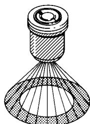
3. Крупнокапельные наконечники устанавливаются совместно с коническими наконечниками и создают аналогичный рисунок распыления. Не понижая давления, с их помощью можно получить более крупные капли, что снижает риск сноса капель ветром в плохую погоду. Поскольку крупные капли понижают укрывистость, рекомендуется увеличить расход жидкости на 10%.
