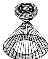
2. Наконечник с коническим факелом распыла снабжён завихрительной пластиной, благодаря которой создается конусообразный рисунок распыления с полым центром. Этот наконечник используется главным образом для распыления инсектицидов и фунгицидов.
