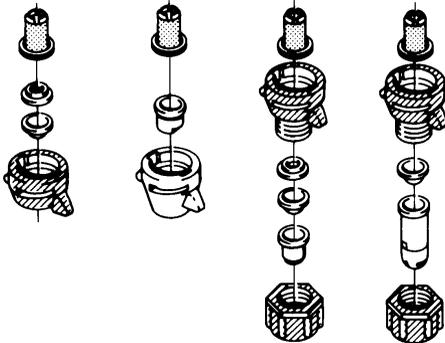
Im einzelnen sind die Düsen in der abgebildeten Reihenfolge zu montieren. Die Schaumdüsen werden ohne Drallkörper montiert. Der Adapter (Nr. 322068) ist für die Montage mit Grosstropfenvorsatz und Schaumdüse notwendig.
