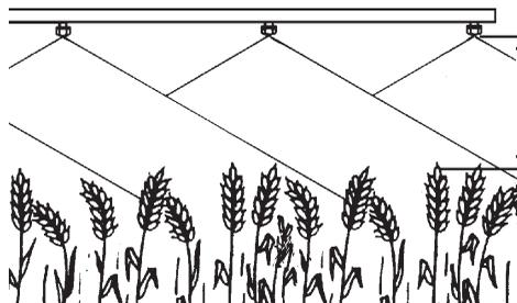
Die optimale Gestängehöhe für 110° Düsen beträgt 40 - 60 cm. Bei zu grosser Höhe wird die Abdrift erhöht, bei zu geringem Abstand ergibt sich zu geringe Überlappung und damit eine ungleichmässige Querverteilung.
