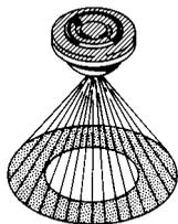
2. Die Kegeldüse besitzt einen Drallkörper, der einen Hohlkegel formt. Hohlkegeldüsen finden bei der Ausbringung von Fungiziden und Insektiziden Verwendung.
