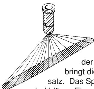
4. Die Schaumdüse wird zusammen mit der Kegeldüse ohne Drallkörper montiert und bringt dieselben Vorteile wie der Grosstropfenvorsatz. Das Spritzbild entspricht eine Weitwinkelflachstrahldüse. Einsatzgebiet ist wiederum die Ausbringung von Herbiziden wenn Windtrift verhindert werden muss und die Flüssigdüngung. Der Zusatz eines Schaummittels ist für die Funktion nicht unbedingt erforderlich.
