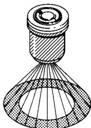
3. Ein ähnliches Bild ergibt die Kegeldüse mit Grosstropfenvorsatz. Bei gleichem Druck entsteht jedoch ein gröberes Tropfenspektrum, wodurch wiederum die Abtriftgefahr vermindert wird. Die grossen Tropfen werden jedoch schlechter angelagert, so dass diese Düse hauptsächlich für die Ausbringung von Bodenherbiziden und Flüssigdünger eingesetzt wird.
