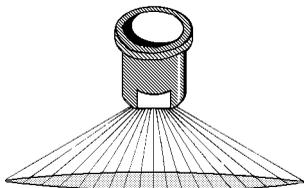
1. Die Flachstrahldüse erzeugt ein elliptisches Spritzbild. Sie ist heute am weitesten verbreitet und kann nicht nur für die Herbizidausbringung sondern auch für den Fungizid- und Insektizideinsatz Verwendung finden. Bei niedrigen Drucken besitzt die Mehrbereichsflachstrahldüse relativ grosse Tröpfchen (MVD) und ist deshalb weniger abtriftgefährdet.
