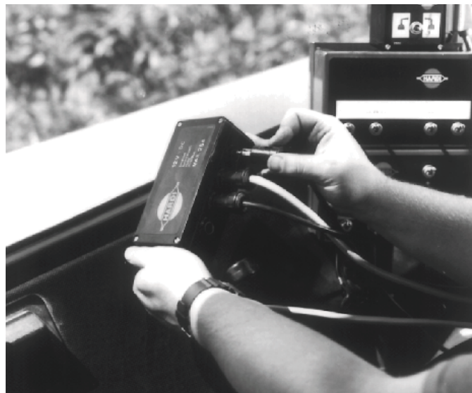
Boîte de jonction de 12 volts (#817925) pour connexion de 12 volts.
