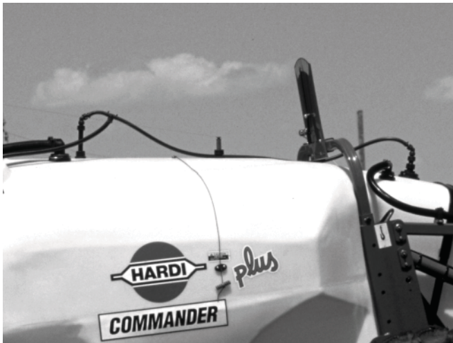
Buses de rinçage sur le dessus du réservoir
