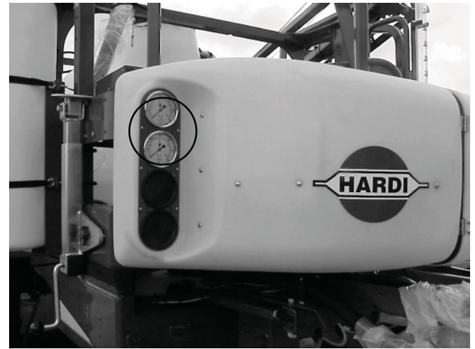
Jauges de pression de la rampe et du collecteur
