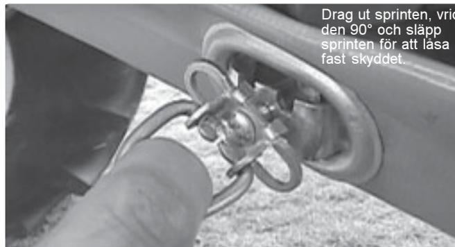
Drag ut sprinten, vrid den 90° och släpp sprinten för att låsa fast skyddet.
