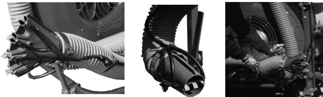
Les becs du modèle Paraflow pneumatique peuvent aussi être ajustés individuellement afin de les diriger vers les endroits qu'on désire traiter.
