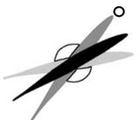
**45 degrés (position 3)** Pour les tracteurs dont la puissance est supérieure à 55 CV (40 kW).
