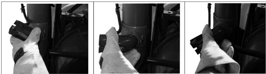
La hauteur des becs peut aussi être ajustée et, pour accommoder l'écartement des rangs, la largeur peut être modifiée. Desserrez l'écrou (S), puis remontez ou descendez le support. Pour changer la largeur, desserrez les deux écrous (T).
